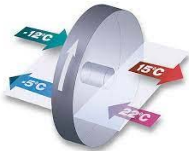
Rotierende Speichermasse Feststehende Luftführung
